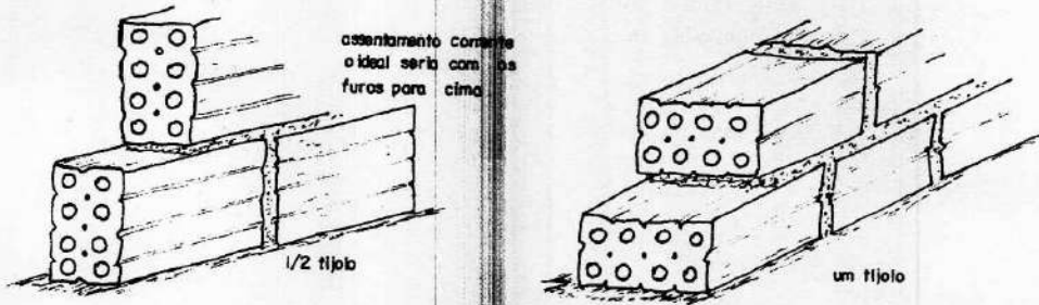
Figura 1 - Execução de alvenaria utilizando tijolos furados.
