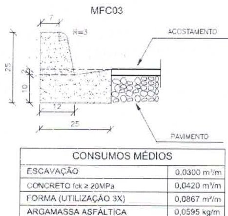
Figura 06 – Detalhe Meio-fio conjugado com sarjeta
