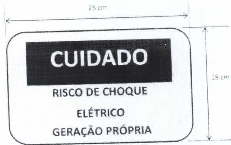
Figura 3: Placa de advertência.
