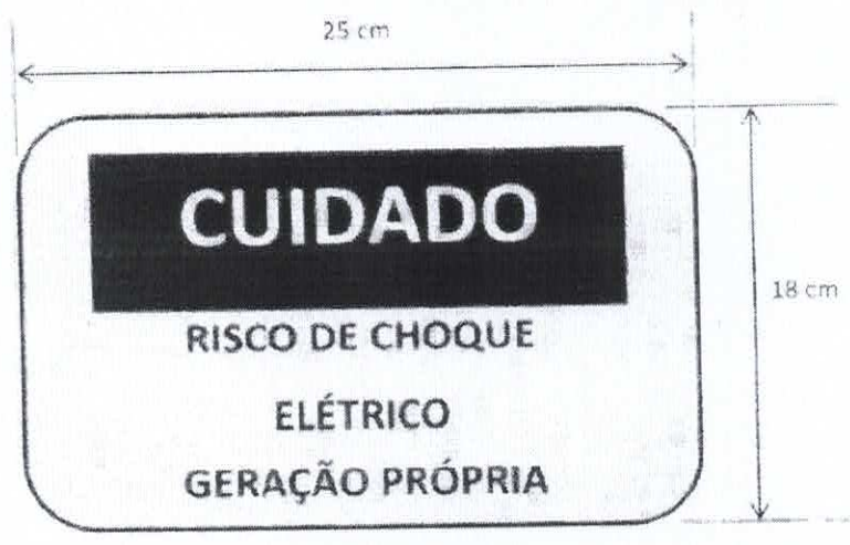
Figura 3: Placa de advertência.
