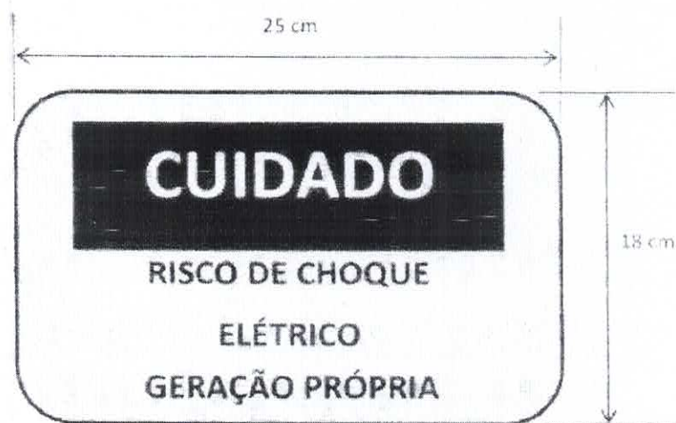
Figura 3: Placa de advertência.
